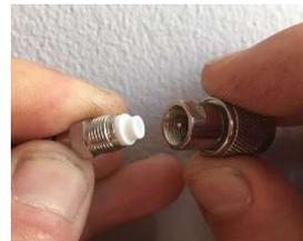
*Conector FME y adaptador FME-TNC*
