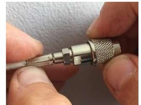
*Conector FME firmemente enroscado*
