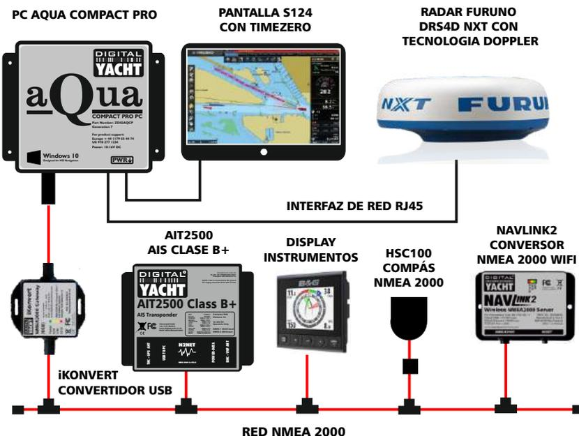
Este sistema de navegación integra el PC Aqua Compact Pro con un radar Furuno DRS4D NXT con tecnología doppler, el programa TimeZero Navigator con el módulo Radar y una red NMEA 2000 utilizando el iKonvert, el convertidor NMEA2000 USB de Digital Yacht. Los datos AIS, GPS y NMEA 2000 de los instrumentos puede ser utilizados por los programas de navegación gracias a esta interfaz bidireccional.
