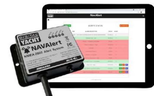
NavAlert permite establecer una alarma para cualquier parámetro disponible en la red NMEA 2000 del barco. Pueden ser datos de navegación como la profundidad, el rumbo o la velocidad, datos eléctricos como el voltaje y datos del motor/generador como la temperatura, la presión, el nivel del depósito, etc. NavAlert también cuenta con una alarmas de fondeo y alarma anticollisión CPA y TCPA.
