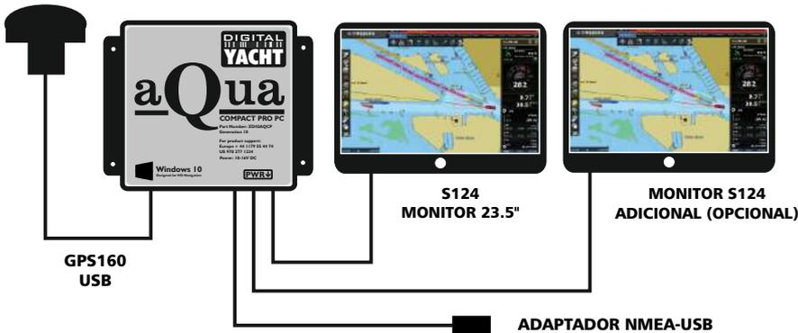
El Aqua Compact Pro PC de Digital Yacht ofrece un sistema de navegación PC asequible y fiable para embarcaciones. El PC Aqua funciona directamente en CC, es de bajo consumo y cuenta con la última tecnología Intel de 12ª generación, WiFi y Bluetooth integrados y SSD con 8 GB de RAM.
